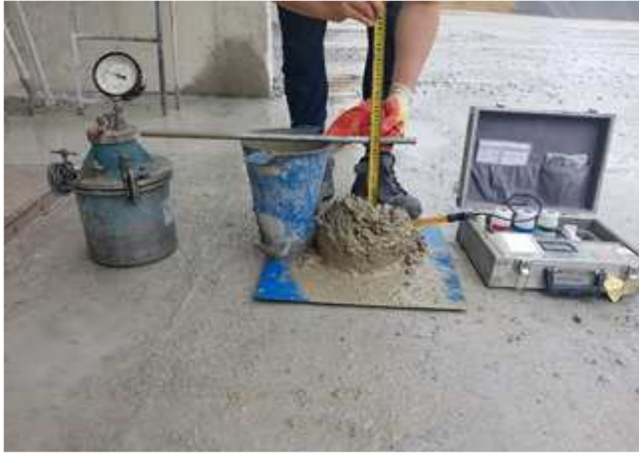
라이닝 콘크리트 슬럼프 시험
